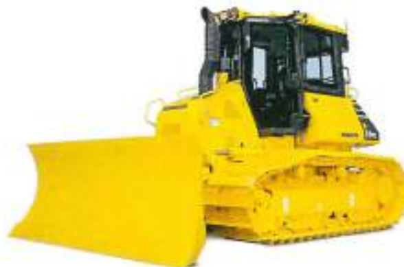
19 pav. Vikšrinis buldozeris Komatsu D5 1PX-24E0
